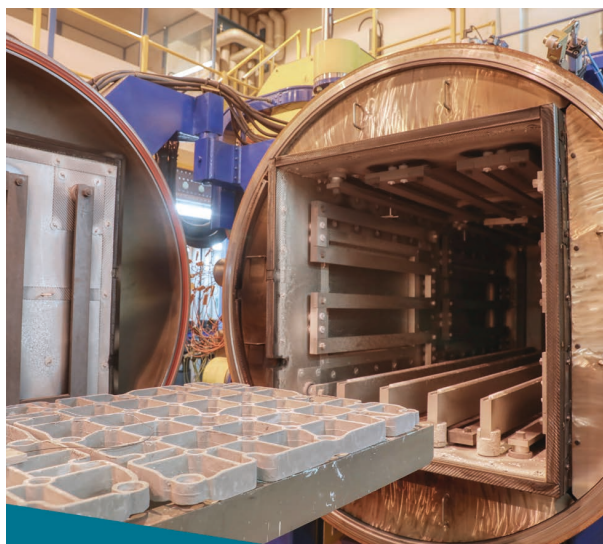
Figure 4A - Four de traitement thermique sous vide ou atmosphère contrôlée : T_{\max} = 1300\text{ }^{\circ}\text{C} , capacité maximale L \times l \times h : 2400 \times 80 \times 80\text{ cm}^3 , charge 3000 kg.
