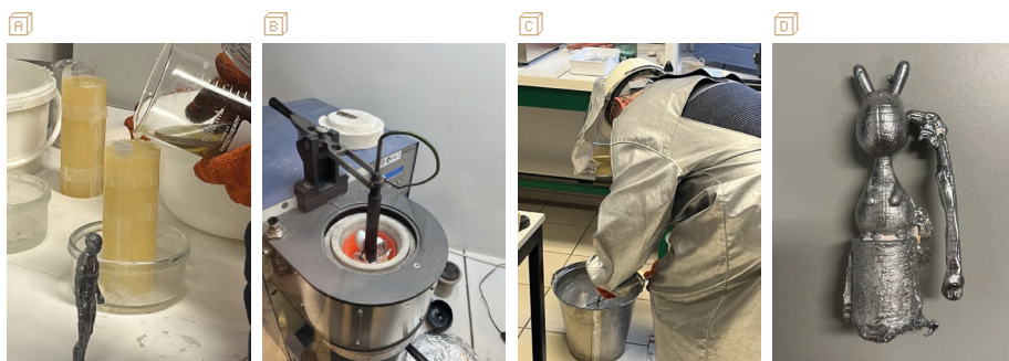
Figure 3 - [A] Préparation du modèle en cire - [B] Fusion de l'aluminium dans un four à induction [C] Trempe pour démoulage - [D] Figurine démoulée.
