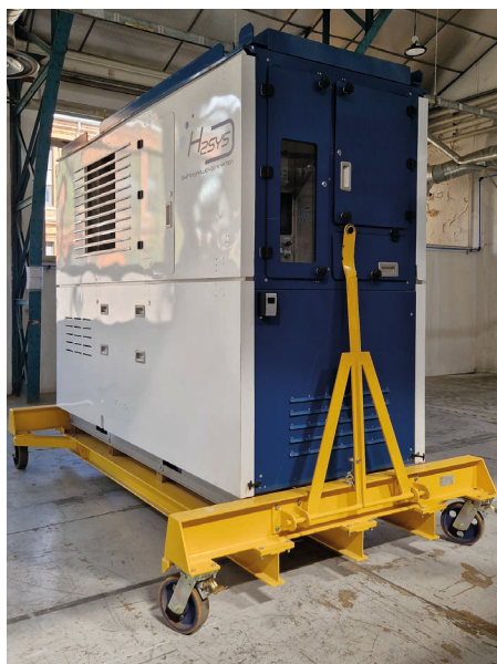
Figure 3 - Groupe électrogène H_2 fabriqué par H2SYS.
