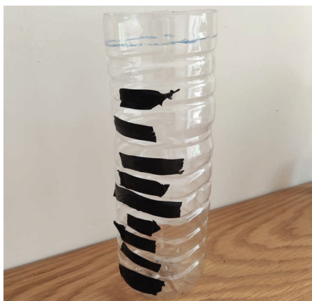
Figure 1 - Bouteille d'eau utilisée pour cette expérience (les trous sont réalisés à l'aide d'une perceuse et d'une mèche de 5 mm).
