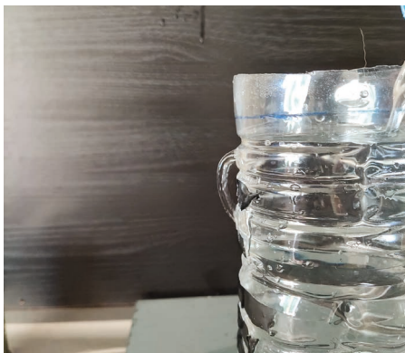
Figure 10 - Mise en avant des limites du modèle. A Une photo de l'expérience avec le trou 9 où le jet n'est pas totalement horizontal en sortie de l'orifice et B une mise en avant de l'effet de tension superficielle pouvant apparaître avec le trou 11 et une faible vitesse de jet en sortie).
