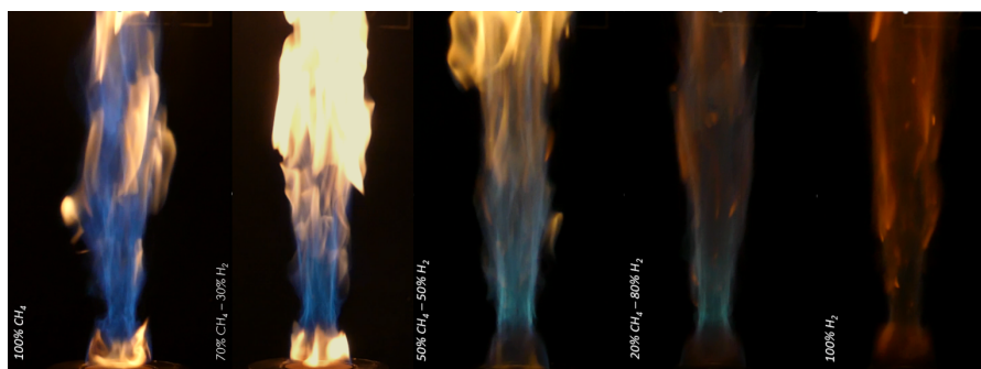
Combustion de mélanges méthane-hydrogène. (© CORIA)
