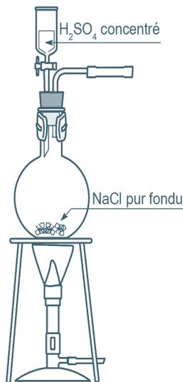
Figure 1 - Réacteur de préparation de  $\text{HCl}_{(g)}$ .
